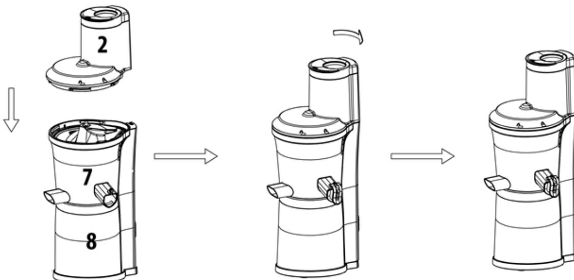
Поместите загрузочную трубу (2) таким образом, чтобы символ на трубе оказался над символом на средней части прибора (7). Нажмите и поверните по часовой стрелке таким образом, чтобы символ на загрузочной трубе (2) оказался над символом на средней части прибора (7).
