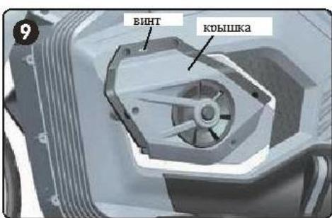
9. Установите крышку двигателя. Зафиксируйте.
