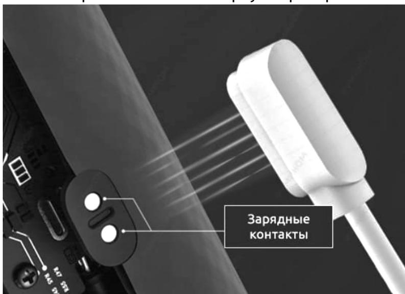
Затем подключите шнур к любому разъему USB с силой тока не менее 1 А. Время полной зарядки составляет ~3 часа. Отслеживать ход зарядки вы можете с помощью кольцевого светодиодного индикатора на корпусе.
