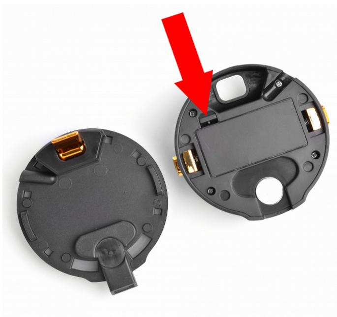
Откройте крышку батарейного отсека, нажав на защелку (показана стрелкой). Установите в отсек две батарейки формата ААА, соблюдая полярность, как показано на иллюстрации ниже.
