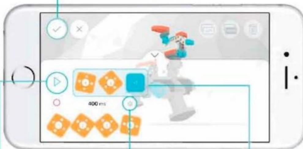
Воспроизведение действия    Регулировка времени действия    Регулировка угла сервопривода
