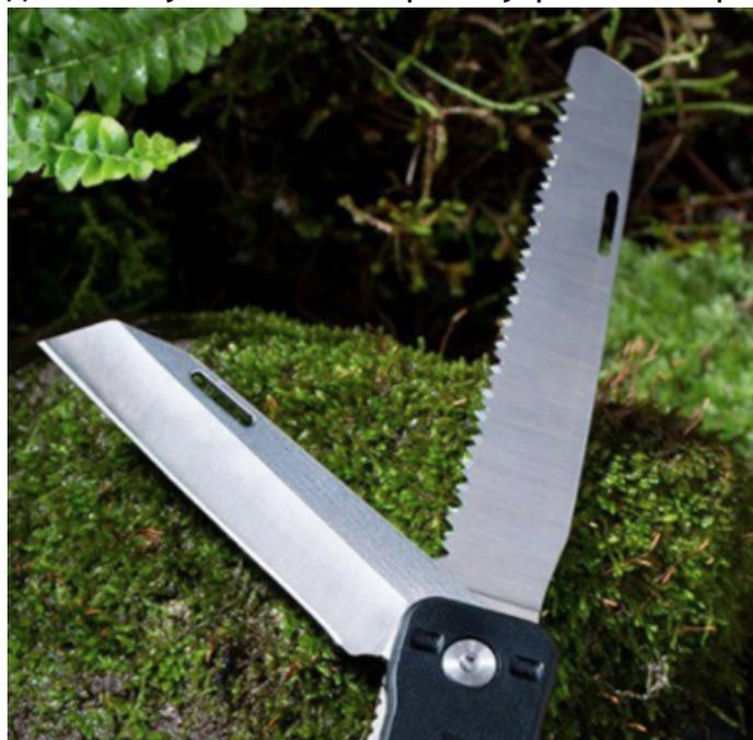
Нож можно использовать как самостоятельный инструмент или присоединить к рукоятке мультитула. Для этого откройте клинок-пилу, затем откиньте хвостовик на конце рукоятки ножа, выверните болт-фиксатор на рукоятке мультитула и проденьте его в отверстие на рукоятке ножа. После этого плотно
