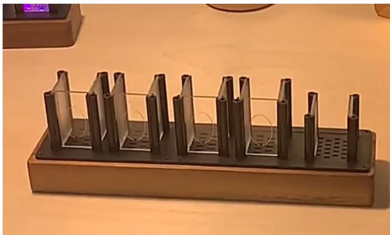
После установки акриловых панелей необходимо произвести монтаж деревянных деталей корпуса, удерживающих акриловые панели. Для этого в комплекте поставляются деревянные детали, крепежи и инструменты (отвертка и шестигранник). Закрепите отверткой деревянные детали так, как это показано на изображении ниже.
