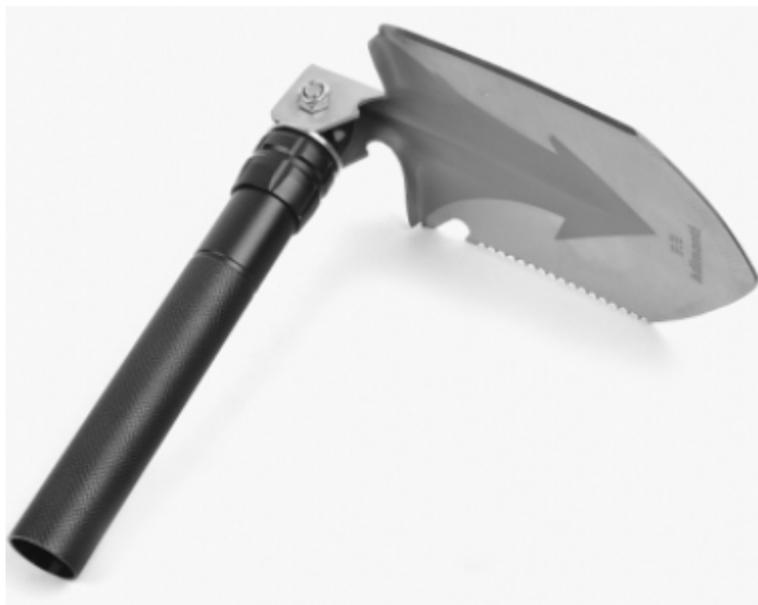
Для того чтобы изменить положение штыка лопаты, вращайте фиксатор рабочего полотна (цилиндр с насечкой, расположенный прямо под штыком лопаты) против часовой стрелки. После этого установите штык в одном из трех положений — сложен, разложен под углом 90 градусов, разложен полностью — и плотно затяните фиксатор, вращая его по часовой стрелке.
