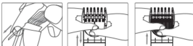
Как установить. Соотнесите насадку-гребень с пазами на каждой из сторон машинки и двигайте ее вдоль пазов, пока не услышите щелчок.
