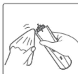
С помощью щетки смахните волосы с корпуса машинки, лезвия и режущей головки. Промойте корпус машинки водой. После очищения насухо вытрите устройство и смажьте маслом режущую головку. Запрещается производить очистку бензином, спиртосодержащими веществами, растворителями или другими агрессивными химическими веществами. Запрещается самостоятельный разбор и ремонт устройства. При поломке обратитесь в сервисный центр.
