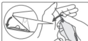
Чтобы отсоединить режущую головку, выключите устройство и большим пальцем надавите на зубья головки по направлению, указанном на рисунке слева.
