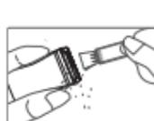
Используйте щетку для очищения волос с корпуса машинки (относится ко всем насадкам). Удалите щеткой волоски, которые застряли между зубьями режущей головки. Нажимая на лезвие машинки вперед и назад по направлению движения зубьев, очистите пространство между зубьями с помощью щетки.
