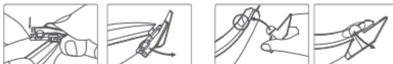
Как установить. Соотнесите насадку-гребень с пазами на каждой из сторон машинки. Закрепите сначала одну сторону, затем вторую. При правильной установке должен раздаться щелчок.
