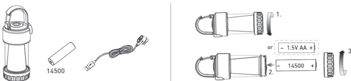
Для питания светильника можно использовать аккумулятор формата 14500 или батарейку формата AA («пальчиковая» батарейка). Для того чтобы установить их, откройте батарейный отсек, повернув нижнюю часть корпуса против часовой стрелки, а затем потянув ее на себя. Установите выбранный элемент питания, а затем закройте крышку, повернув ее в обратном направлении.
