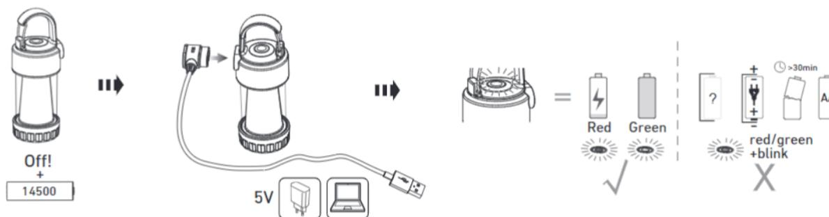
**Внимание!** Светильник можно подзаряжать только в выключенном состоянии. Режим «сквозной» подзарядки (например, питание работающего фонаря от пауэрбанка) не поддерживается!
