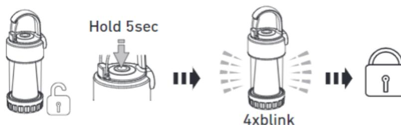
Для этого нажмите и удерживайте кнопку в течение 5 секунд. После этого светильник мигнет 4 раза и будет включена блокировка. Для того чтобы снять блокировку, нажмите и удерживайте кнопку в течение 3 секунд. При этом светильник также мигнет 4 раза.
