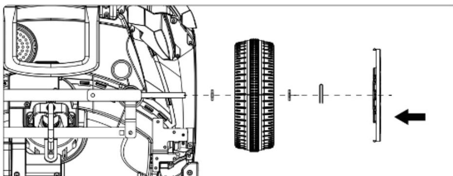
Установите ведущие колеса на заднюю ось. Зафиксируйте их и установите диски.
