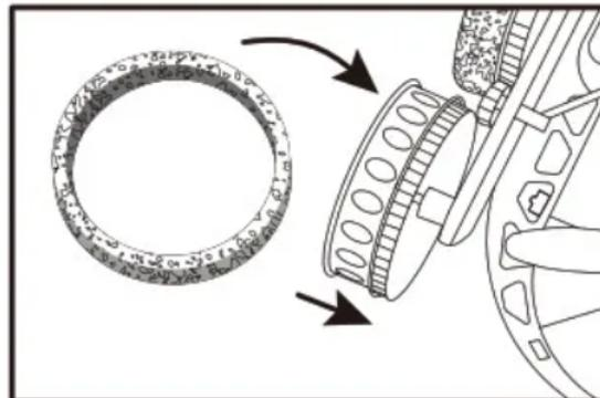
Соблюдайте осторожность, чтобы не порвать шину. Колесо может сместиться при замене шины или из-за падения вездехода. Если это произошло, аккуратно верните его на место так, чтобы зубчики на ободе колеса вошли в зацепление с шестеренкой.
