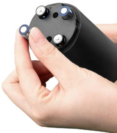
Установите в батарейный отсек четыре батарейки формата АА («пальчиковые»), соблюдая полярность, как показано на иллюстрации (возле каждого места для батарейки обозначен тот полюс, который должен смотреть вверх). Для питания устройства рекомендуется использовать качественные щелочные (алкалиновые) батарейки ведущих производителей.
