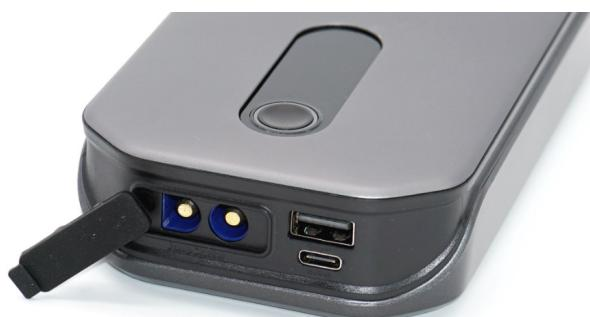
1. Для подзарядки используется кабель с разъемами USB Type-C и USB
