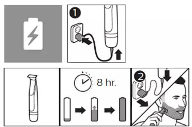
При зарядки на ручке триммера горит красный светодиодный индикатор. Он погаснет, когда процесс будет завершен.
