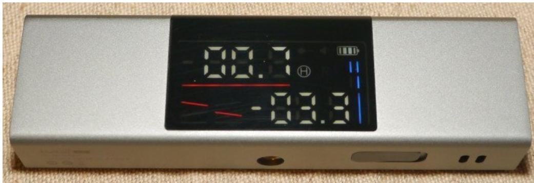
Помимо измерения абсолютных углов, доступен режим измерения относительных углов. Для включения режима нужно нажать и удерживать левую кнопку управления. После включения режима на экране высветится буква R и значения углов обнулятся. Теперь базовым считается положение, в котором угломер был в момент включения этого режима, и все углы измеряются от этой базы. Режим удобен, когда нужно измерить угол между двумя объектами.
