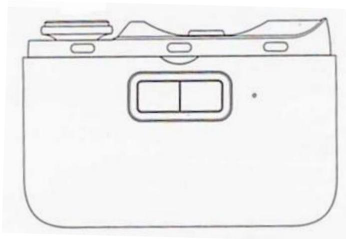
В каждой функции предусмотрено 2 режима мощности. После активации нужной функции нажмите кнопку повторно, чтобы выбрать более мощный режим. Если после этого вновь нажать кнопку, машинка выключится.
