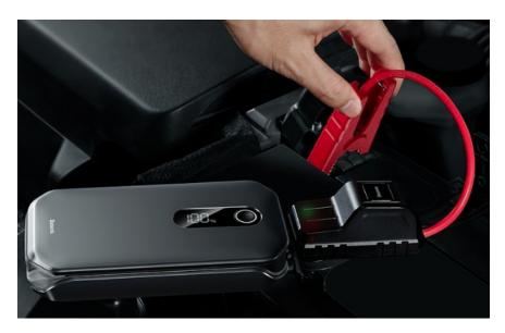
• Подсоедините зажимы аккумулятора автомобиля, соблюдая полярность. Красный зажим должен быть подключен к положительному (+) контакту,
