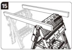
Чтобы использовать Pegasus в качестве козел, полностью раскройте ножки, пока лоток для инструментов не станет горизонтально. Он совместим с зажимными козлами производства нашей компании (не входят в комплект поставки). (Рис. 15)
