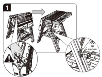
Чтобы использовать Pegasus в качестве верстака, полностью раздвиньте ножки и потяните поверхность стола вверх, пока фиксаторы не защелкнутся. (Рис. 1).
