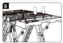
Вставьте зажимные колодки в нужные отверстия на рабочем столе. (Рис. 5)
