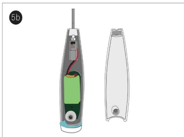
5. Вскройте пластиковый корпус, используя отвертку.
